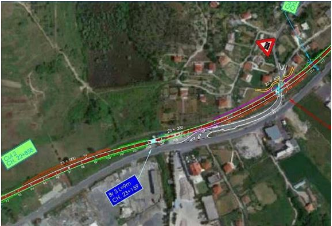
Figure 2.9_Permirësimi horizontal ne afersi te Vores, nga km 22+915 ne km 23+600
